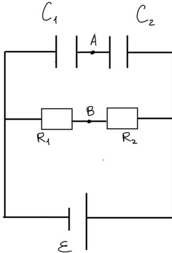
Для решения задачи проставим потенциалы на источнике и в точках А и В (рис. 1). Найдём силу тока в цепи по закону Ома, учитывая последовательное соединение проводников:
